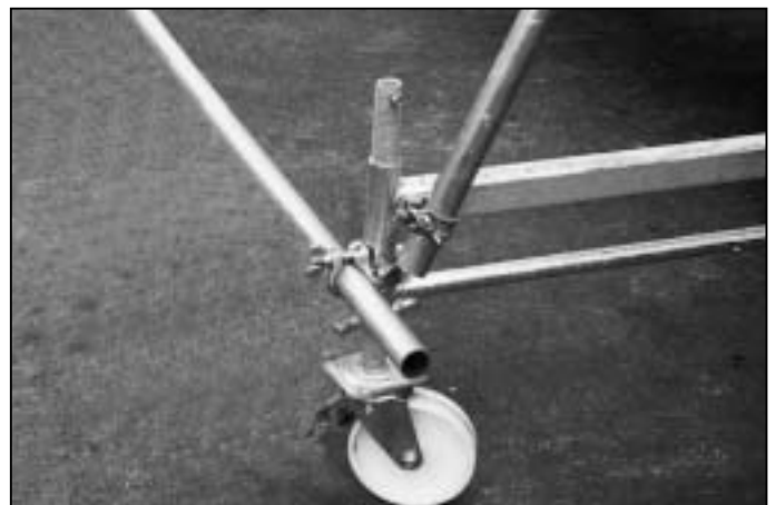
22. Alu-Strebe 3,00 m (6) an die außenliegenden Kupplungen an den Fahrbalken (9) einführen und Alu-Strebe nach oben zu den Leiterrahmen abstreben.
