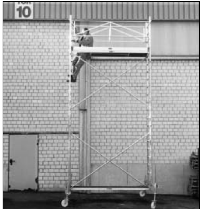
20. Fertiggestelltes Rollgerüst Typ 70/4.
